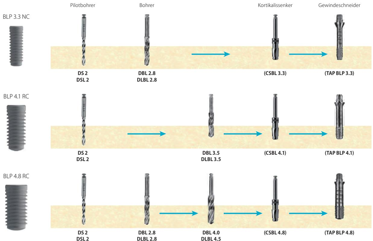
Aufgrund der hohen Qualität unserer Bohrer kann nach der Pilotbohrung sofort die Finalbohrung erfolgen.
